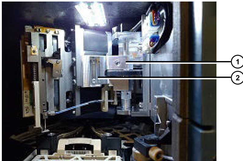
图 8-44： 针架臂中的磁铁位置
