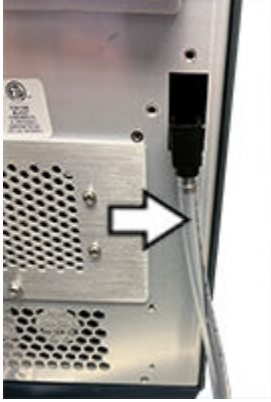
图 4-22：断开冷凝废液管路
