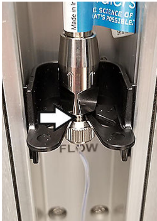
图 4-4： 色谱柱安装在色谱柱夹中
